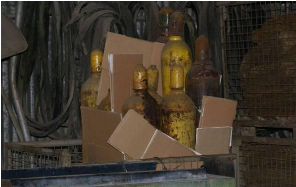
نگهداری غیر استاندارد سیلندره‌های ایستاده‌ی کلر در انبار
